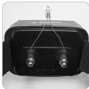
Sposób przymocowania lampki testowej
