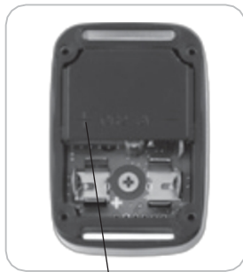
Oznaczenie biegunowości akumulatora
